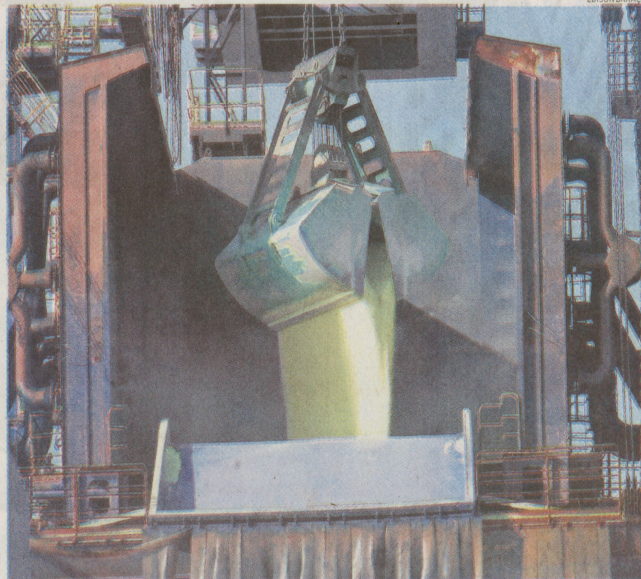
Problema apontado pela fiscalização estava na esteira que apara o produto lançado pelo grab no porão
